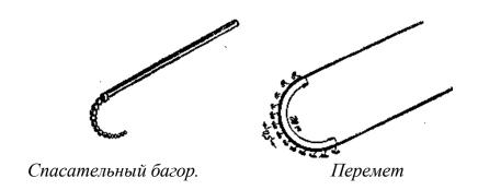
**Перемет** служит для поиска утонувшего. Он представляет собой конец длиной  $40 \, M$ , диаметром  $25 \, MM$  с подвешенными к нему маленькими четырехлапыми кошками. Трос на протяжении  $10 \, M$  с обоих концов свободный, а на средних  $20 \, M$  метрах имеет укрепленные кошки в  $0.5 \, M$  друг от друга.
